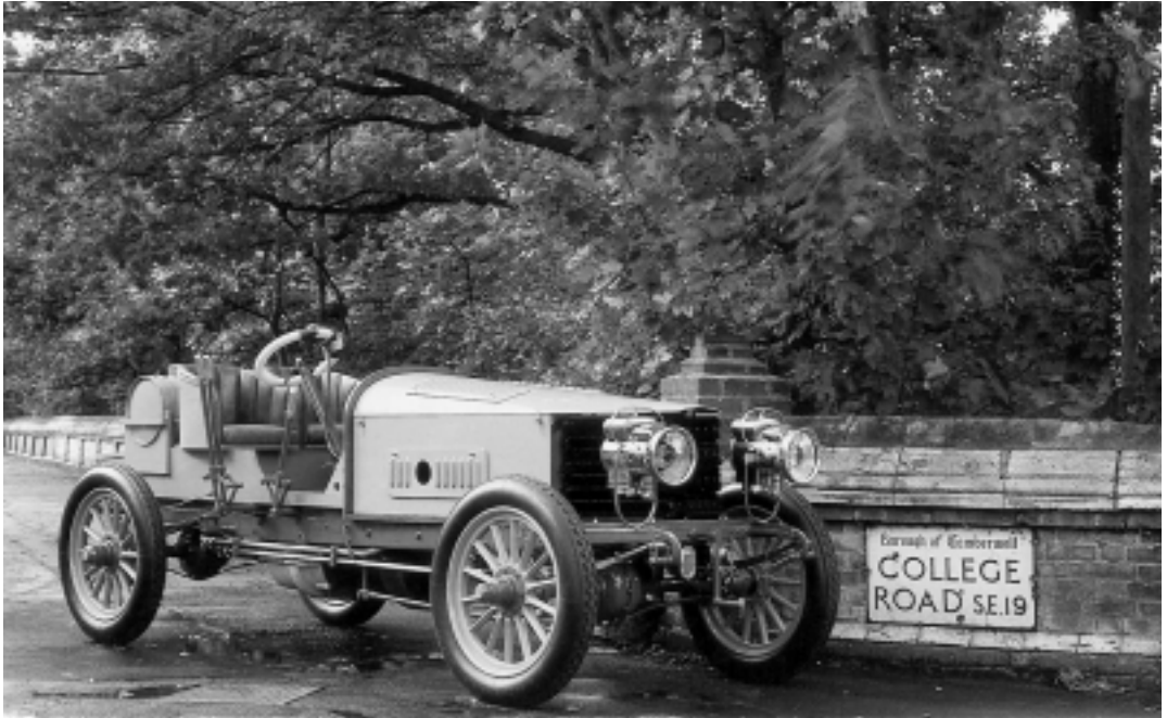
De 60 PK-Spyker uit 1903 was de eerste auto ter wereld met een zescilinder motor en vierwielaandrijving. Foto uit: Spyker, een Nederlands fabrikaat.
