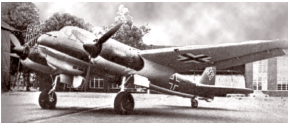
De Junkers Ju88. Een nachtjager van dit type was waarschijnlijk verantwoordelijk voor het verongelukken van het vliegtuig van Hawkes. De Ju88 heeft een bemanning van drie personen. Voorop de neus is de antenne van de Lichtenstein-radar te zien. (foto uit: Wespennest Leeuwarden )
